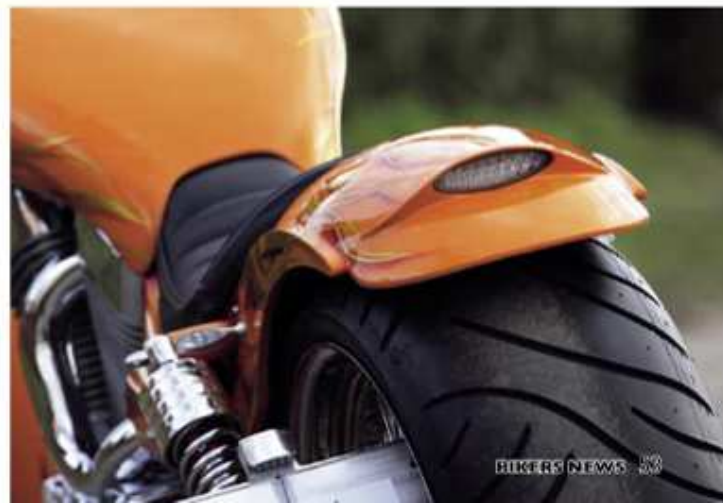
Das LED-Rücklicht ist im neuen Heck integriert, alle Halterungen und Übergänge sind verschweißt und nahtlos verschliffen
