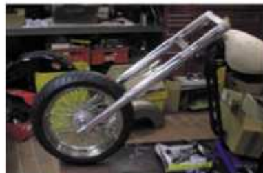
Im original Lenkkopf führt die lange BSB-Gabel mit 14° gerocten Brücken ein TB-Rad. Ihre Covers werden harmo- nisch zur Rockung beschnitten
