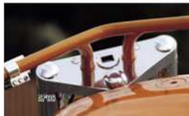
Aktion sauberer Lenker: Innenliegende Leitungen und schlanke Hebeleien mit Mikroschaltern
