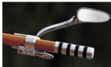
Aktion sauberer Lenker: Innenliegende Leitungen und schlanke Hebeleien mit Mikroschaltern
