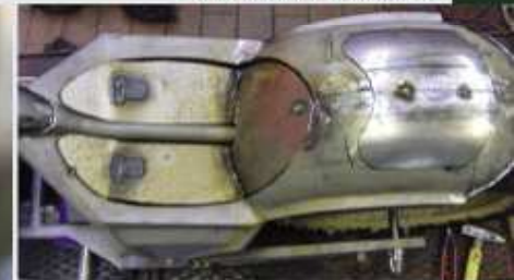
Nach Ausschnitt des Heckblechs wird der Sitzbankboden probeweise eingelassen
