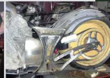
Mit Schläuchen wird eine anschließbare Linie bestimmt, die alle Komponenten flüssig verbindet
