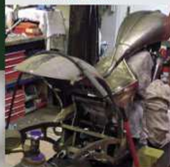
Jede Menge Schweißarbeit bei der komplett neuen Konstruktion des Heckbereichs
