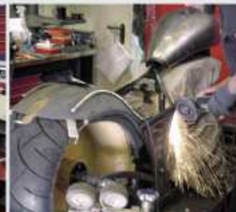
Beim Schmelzen fliegen die Funken, wenn Rahmen, Heckfender und Sitzmulde zurrecht gefügt werden
