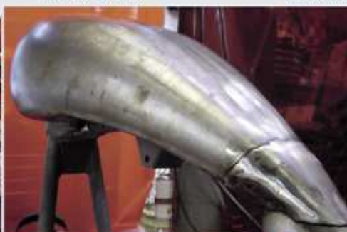
Mit neuen Halterungen und einem zusätzlichen Stretch-Teil fügt sich der Tank zwischen Lenkkopf und Sitzmulde
