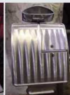
Das Alu des hauseligen Kennzeichenhalters mit Rücklichtgehäuse wird später schwarz beschichtet
