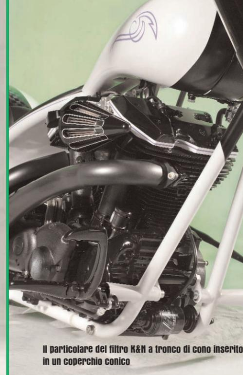
Il particolare del filtro K&N a tronco di cono inserito in un coperchio conico
