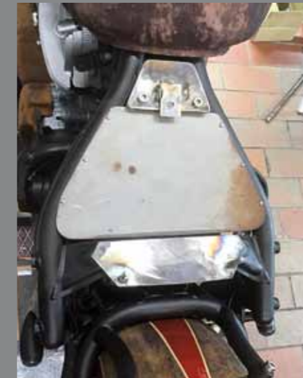
Unter dem Schwingsattel steckt eine neu gefertigte Verblendung
