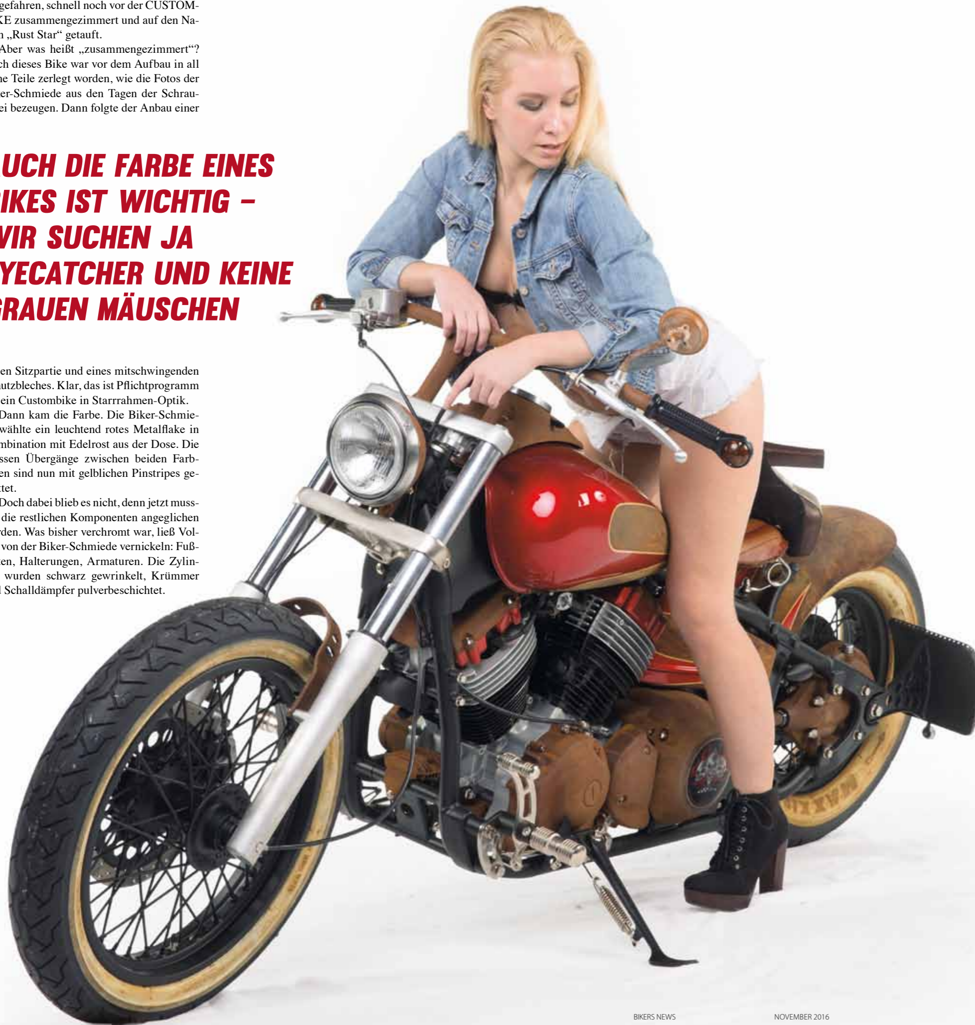
Um allein mit Ochsenaugen fahren zu dürfen, müsste das Bike älter sein. Geschickt hat die Biker-Schmiede deshalb noch kleine Heckblinker an der Schwingensichel untergebracht
