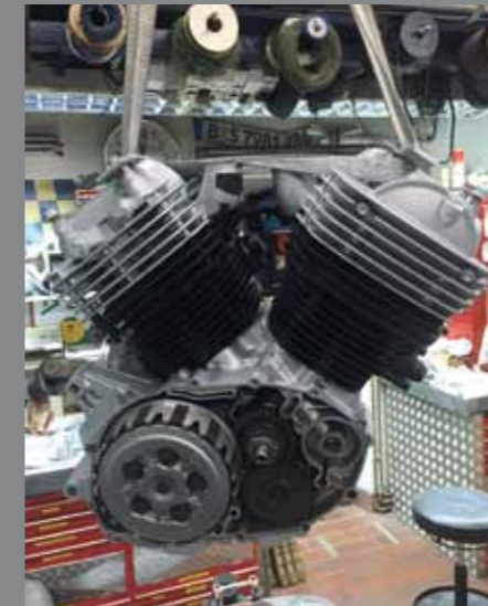
Von wegen nur Farbe. Die Biker-Schmiede hat auch den Motor generalüberholt und die Zylinder gleich mal schwarz gewrinkelt
