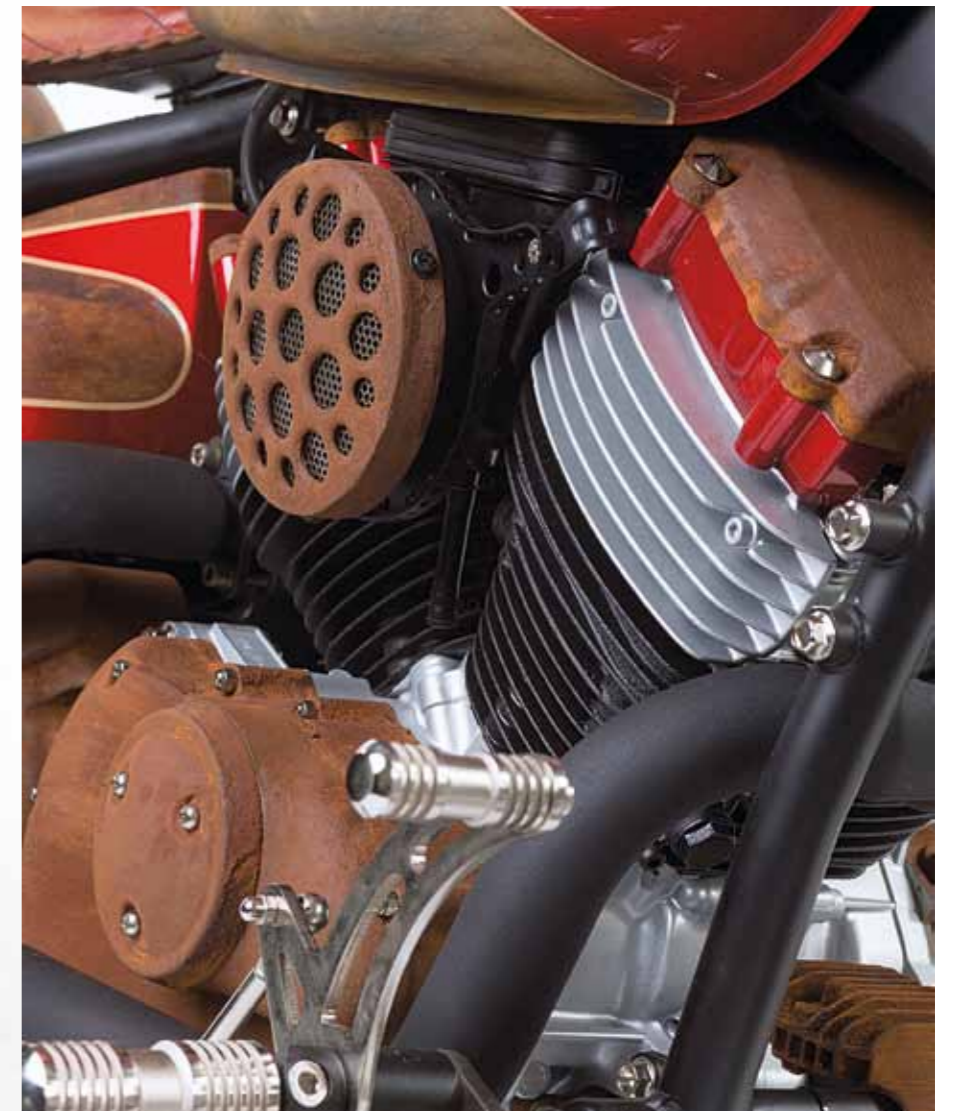
Das Luftfiltergehäuse war mal das Hupencover einer 1400er Drag Star
